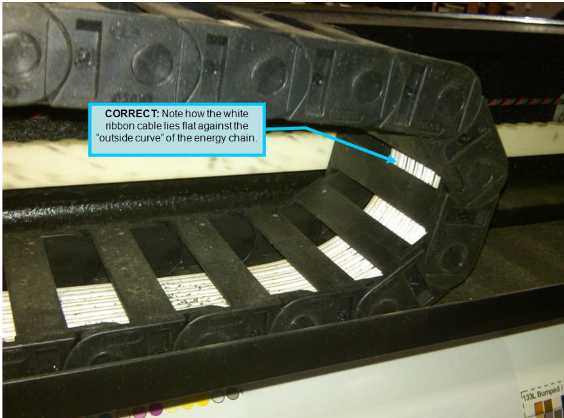
Fig. 57 – Correct Slack
